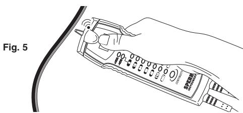
**AVERTISSEMENT** Ne pas placer la main au-delà du bouton. Utilisation : Enfoncer le bouton, placer la pointe du détecteur sur le câble ou l'appareil, ou à proximité de ceux-ci. En cas de tension c.a., le voyant s'allume et le haut-parleur stridule.
