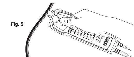
**ADVERTENCIA!** **No coloque la mano mas allá del botón.** Para utilizar, presione el botón y coloque el extremo de detección sobre o cerca del alambre o dispositivo. Si el voltaje de CA está presente, la luz brillará intensamente y el altavoz sonará.
